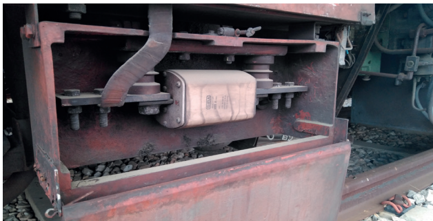
Caja portafusibles y fusible, junto a cofre del seccionador pertenecientes a un 5000 1ª Serie de los vendidos a Buenos Aires.
